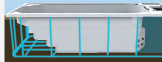
NUR MEHR MIT LEICHTBETON ENTSPRECHEND HINTERFÜLLEN
